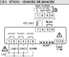
Probe: Pt100= 7 - 9 (8); Thermocouple J, K, S = 7(+); 9(-) 24Vac/cd supply: 11-12
