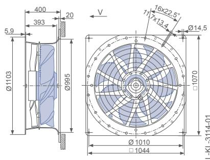
Bauform H - ZAplus Flattop, druckseitiger Berührschutz
