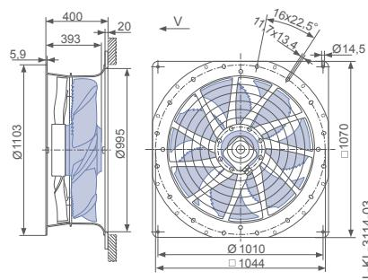
Bauform H - ZAplus Flattop, druckseitiger Berührschutz
