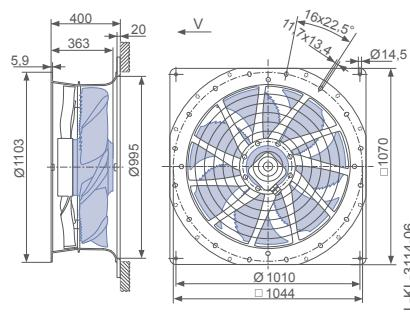
Bauform H - ZAplus Flattop, druckseitiger Berührschutz
