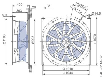
Bauform H - ZAplus Flattop, druckseitiger Berührschutz
