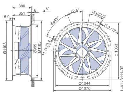
Bauform L - ZAplus OnTop, druckseitiger Berührschutz
