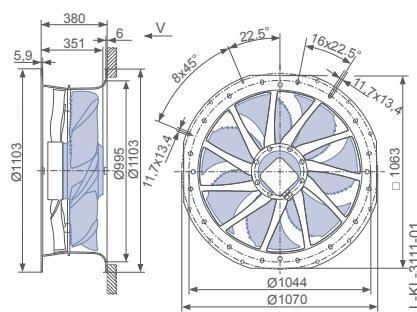
Bauform L - ZAplus On top, druckseitiger Berührschutz
