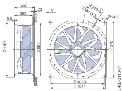
Bauform Q - ZAplus mit Adapterplatte, druckseitiger Berührschutz
